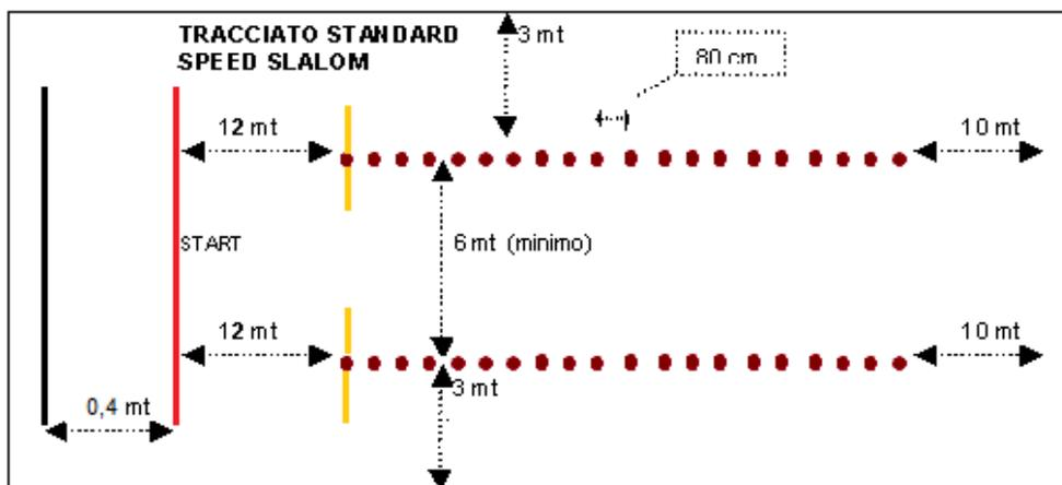
Le fotocellule sono piazzate in modo da rilevare i tempi dalla partenza fino a 80 cm oltre l'altezza dell'ultimo cono, per uno spazio totale di 28 metri.
