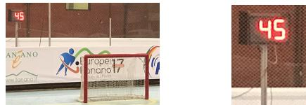
**5.3 ALTURA DE COLOCAÇÃO DOS PAINÉIS LUMINOSOS:** A base para colocação dos painéis luminosos deve ser colocada a uma altura de 1,40 metros relativamente ao piso, como abaixo se exemplifica:
